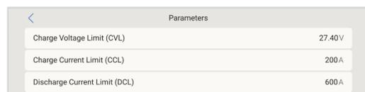
Cuando invierten (es decir, en modo isla) los Multi y los Quattro se apagarán si la corriente de descarga máxima está fijada en cero. Volverán a empezar automáticamente cuando se restaure la red CA o cuando el BMS aumente la corriente de descarga máxima.
