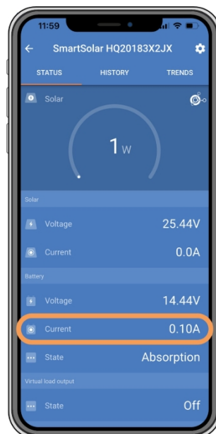
A aplicação VictronConnect mostra uma corrente de carga próxima de zero.
